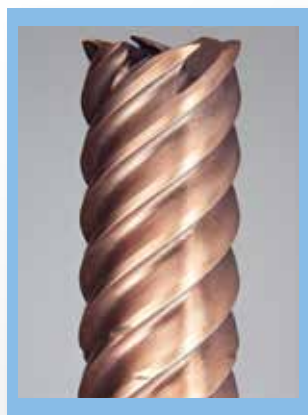
Kopás d8 mm, 58 perc használati idő után
